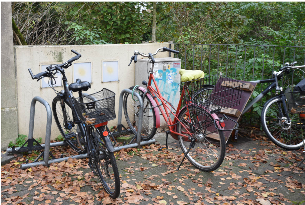
Abbildung 3: Fahrradabstellanlage vom Typ Beta Basis Classico, die nur einseitig benutzbar ist
